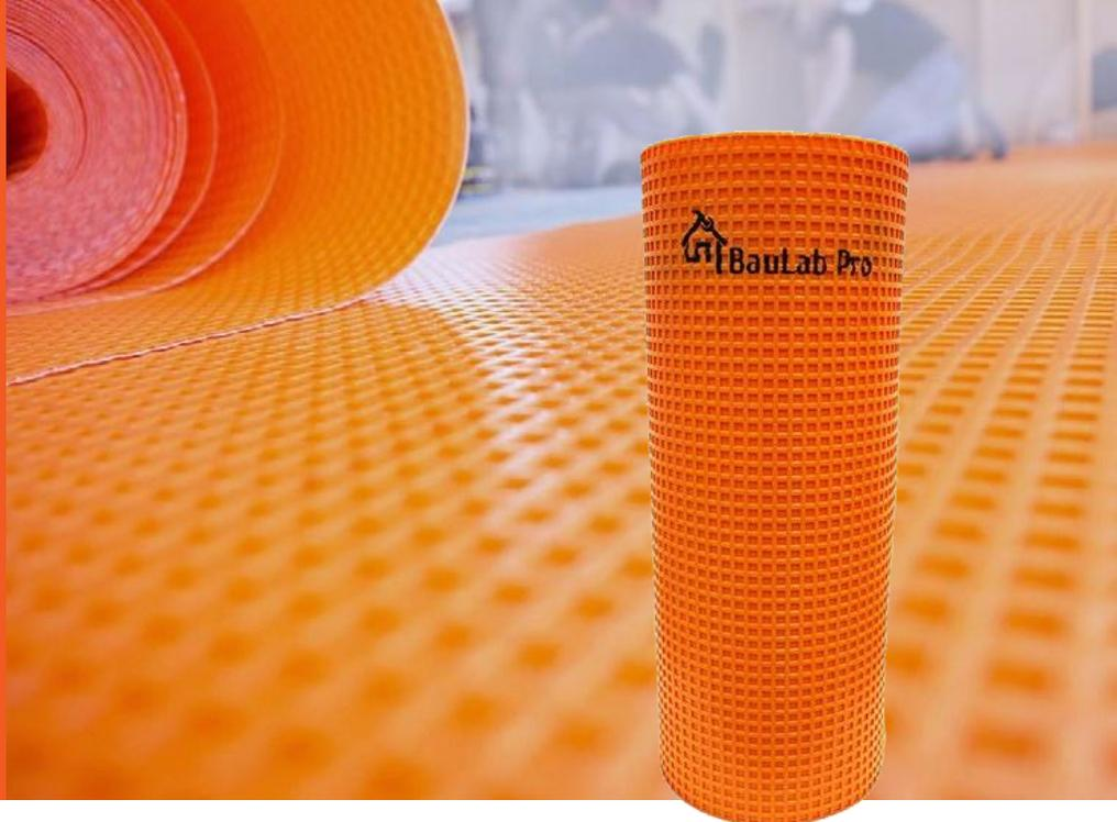
Разделительная мембрана для подготовки сложных оснований (дерево, ОСП, основания с трещинами шириной до 3,5 мм, старая плитка, недосохшие цементные и бетонные стяжки и др.) под облицовку плиточными покрытиями. Изготовлена из полиэтилена высокой прочности, имеет выраженную фактуру в виде квадратных ячеек-углублений в форме «обратный ласточкин хвост». На изнаночную сторону термическим способом прикреплено перфорированное полипропиленовое полотно, имеющее отличную адгезию к плиточным клеям.
